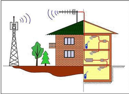
Сигнал от базовой станции принимается наружной направленной антенной, по кабелю поступает на устройство, где этот сигнал усиливается, и по кабелю поступает на внутреннюю антенну, которая переизлучает сигнал к абоненту. При необходимости может быть установлено несколько внутренних антенн, которые подключаются к ретранслятору через разветвители. В помещении уровень сигнала становится достаточным для работы радиотелефона.
